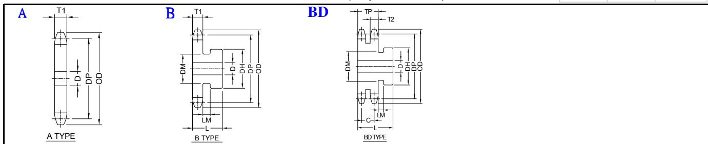
3/8" PITCH (9.525mm) ▲ 表示：有截溝  $T_1=4.3$   $T_2=4.1$   $TP=14.2$   $C=10.13$
